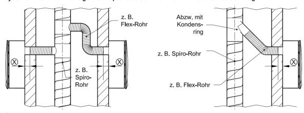
(X) gerade Rohrlänge für den Abluftstutzen min. 55 mm lang, Rohrinnendurchmesser mind. Ø 78 mm.
